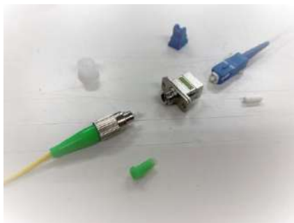
図 1.2-3 アダプタによる光コネクタ接続
